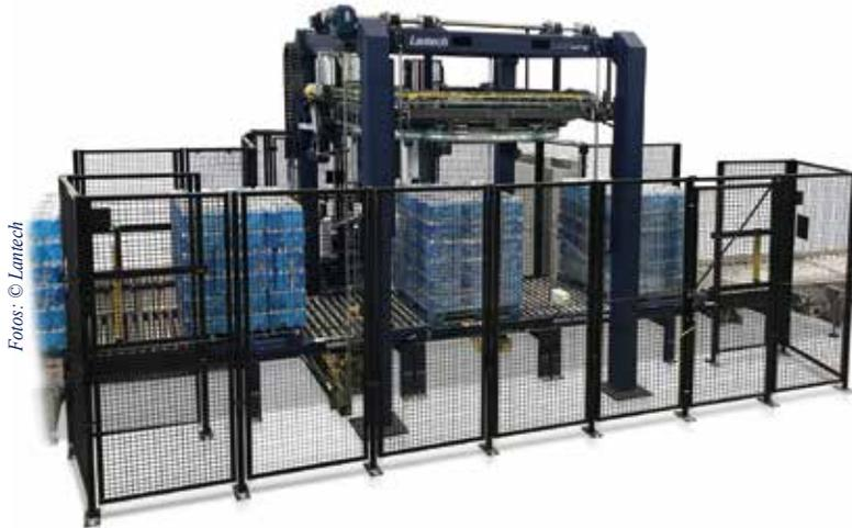
Der vollautomatische Ring-Stretchwickler RL Automatic umwickelt bis zu 180 Ladungen pro Stunde
