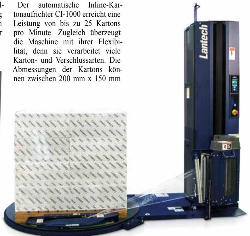
Der halbautomatische Stretchwickler QL-400XT schneidet am Ende des Wickelzyklus die Folie ab
