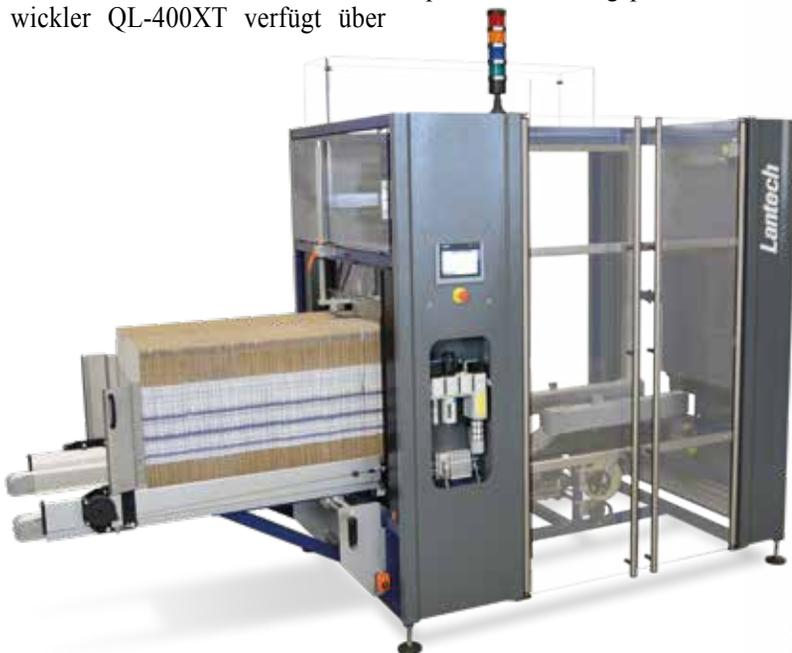
Der automatische Inline-Kartonaufrichter CI-1000 produziert bis zu 25 absolut rechtwinklige Kartons pro Minute.
