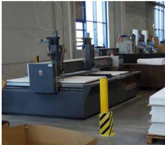
Eine der Wasserstrahlschneidanlagen
