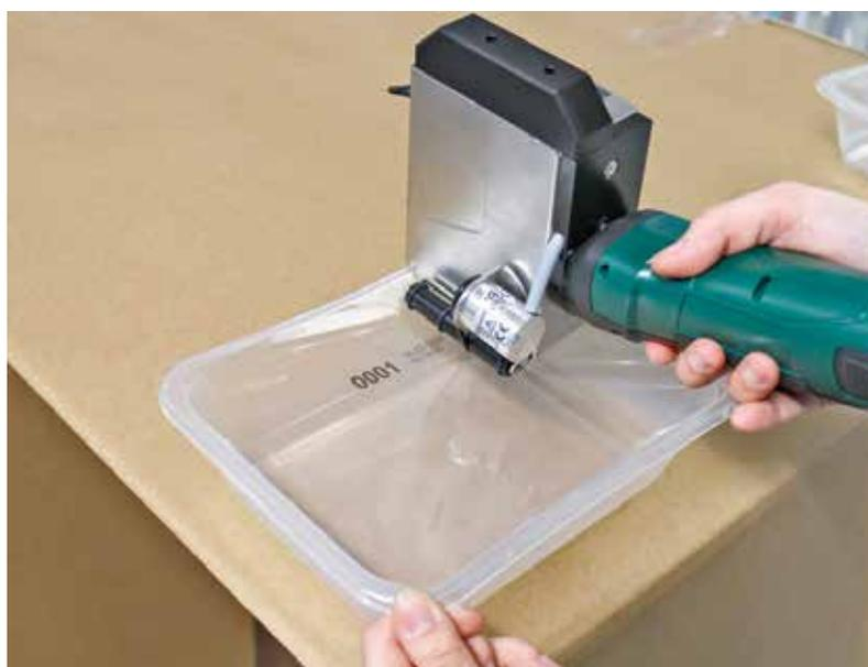
Tiefziehschalen mit Handdrucker X1JET HP bedrucken
