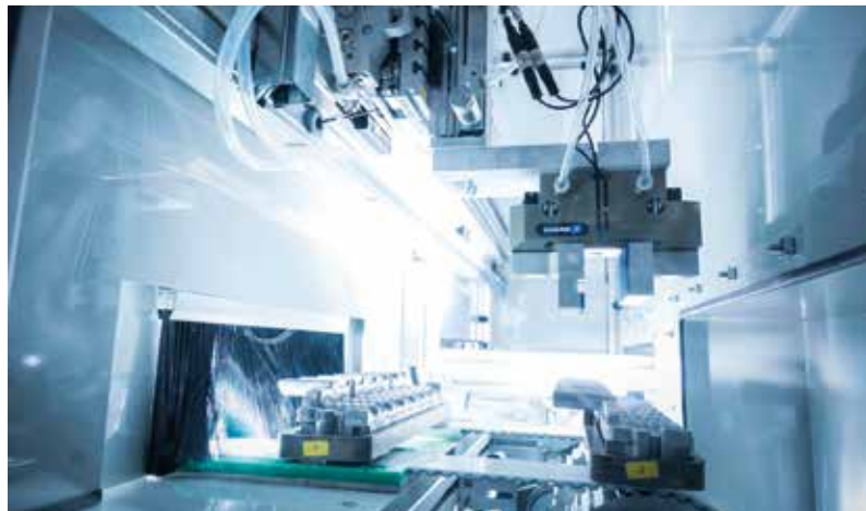
Mit einer hochauflösenden 3D-Kamera erkennt und misst die Easy Branding-Anlage selbstständig über ein beliebiges Förderband zugeführte Werkstücke und sendet die Positionsdaten direkt an den Pick-and-Place-Roboter. Foto: EcoMark GmbH
