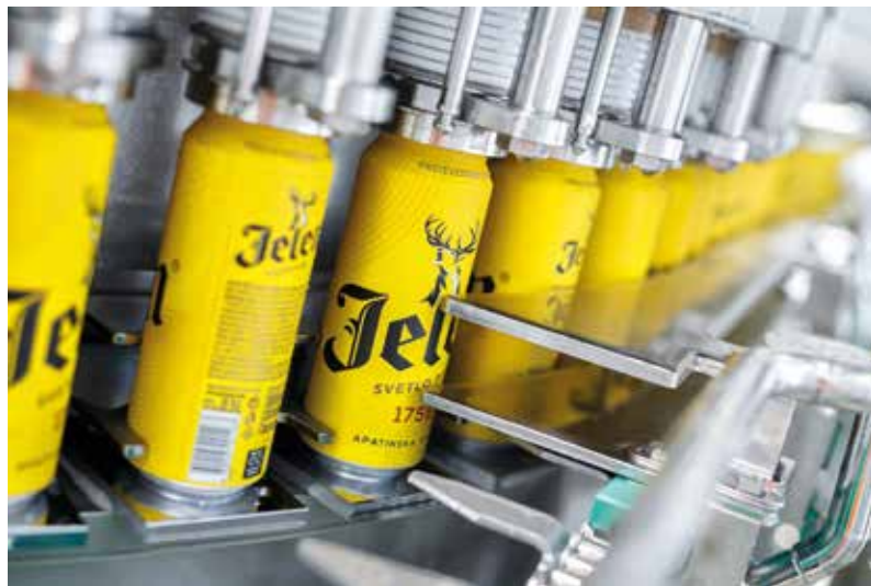
Der neue Füller erlaubt die Verarbeitung von bis zu 25.000 Dosen pro Stunde und punktet in Sachen Nachhaltigkeit und Effizienz.
